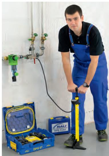
Belastungsprüfung mit Medium Luft, Druckaufbau mit optionaler Druckpumpe DPL Art.-Nr. 332
