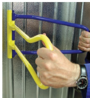
Zum Fixieren der Blechscharn am Dach und an der Fassade
